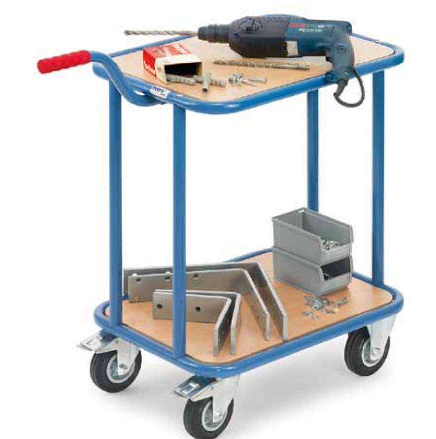
Chariots à col de cygne en tube acier revêtement époxy bleu RAL 5007. Plate-forme en tube acier, en tôle d'acier ou bois, poignée amovible, 1 ou 2 roues fixes et 2 pivotantes avec bandage caoutchouc 125 x 38 mm, moyeu à roulement à rouleaux.
