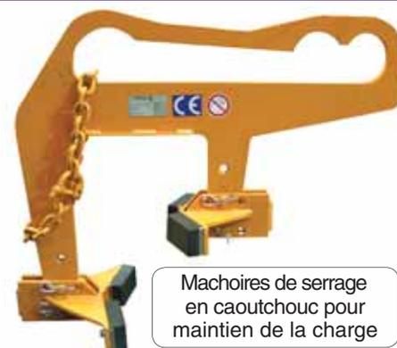
Machoières de serrage en caoutchouc pour maintien de la charge
