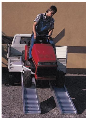
Les rampes AVS 80 permettent le passage de pneumatiques ou de chenilles caoutchouc. En standard chaque rampe est livrée avec une lèvre d'appui munie d'un goujon amovible (longueur 80 mm) et d'un taquet pour ridelle. En option différents types d'accrochage existent (voir fixations). Pour les rebords latéraux 3 possibilités à choisir suivant les repères. Existe en modèle repliable.
