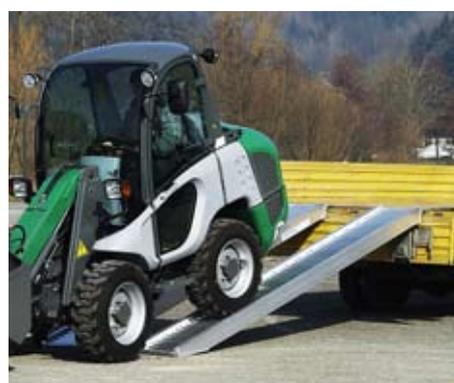
Les rampes AVS 130 permettent le passage de pneumatiques ou de chenilles caoutchouc. En standard, chaque rampe est livrée avec une lèvre d'appui munie d'un goujon amovible (longueur 80 mm) et d'un taquet pour ridelle. En option, différents types d'accrochage existent (voir tableau). Pour les rebords latéraux, 2 possibilités, à choisir suivant les repères. Existe en modèle repliable. N.B. : pour le passage de rouleaux, prévoir un tapis caoutchouc.
