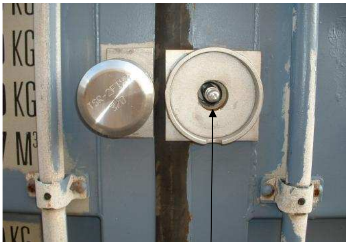
Ancrage maintenu par platine à l'intérieur du véhicule
